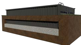
Teilweise im Erdreich versenkt inkl. Verstärkung
